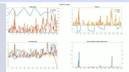
Survitesse dans le réseau à cause du remplissage du réservoir: visualisation de la détection toutes les 10 minutes
